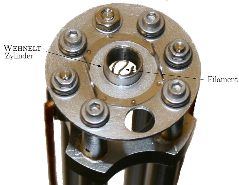
Abbildung 3.4: Foto der Strahlerzeugungseinheit. Zu erkennen sind der WEHNELT-Zylinder, das Rhenium-Filament und eine der zwei seitlichen Zuführungen des Heizstroms.
