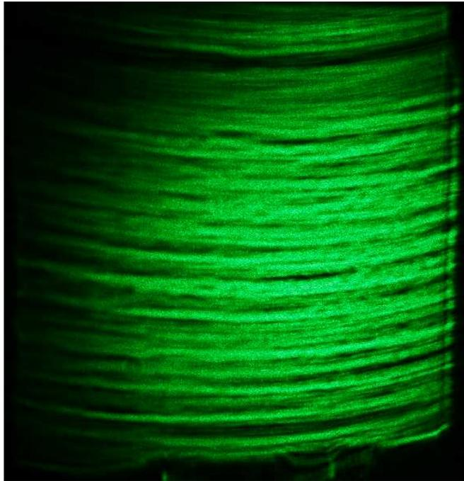
Abbildung 5.4: Bild der Reflexion des Laserstrahls am Kupfer-Nickel-Spiegel (Spiegelfläche: 2 cm  $\times$  2,8 cm).
