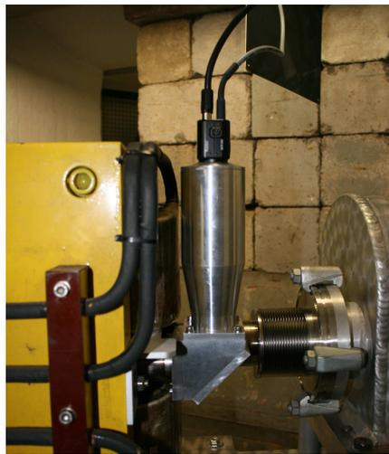
Abbildung 6.2: Synchrotronlichtmonitor am Dipol MB3.
